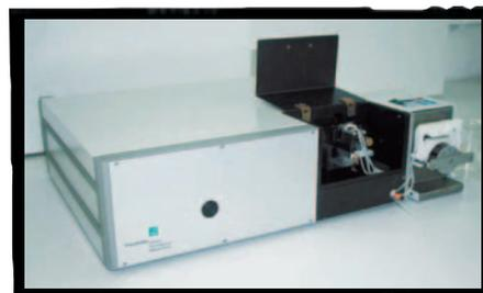
L'Interferometric Biosensor est développé dans le cadre du projet Interreg-Rhenaphotonics. Il est constitué d'une puce photonique sur laquelle sont accrochées les molécules biologiques à étudier - sans qu'il soit nécessaire de les marquer par fluorescence - et d'un faisceau lumineux circulant dans un microguide d'onde intégrée dans la puce. Crédit photo : Institut Fraunhofer
