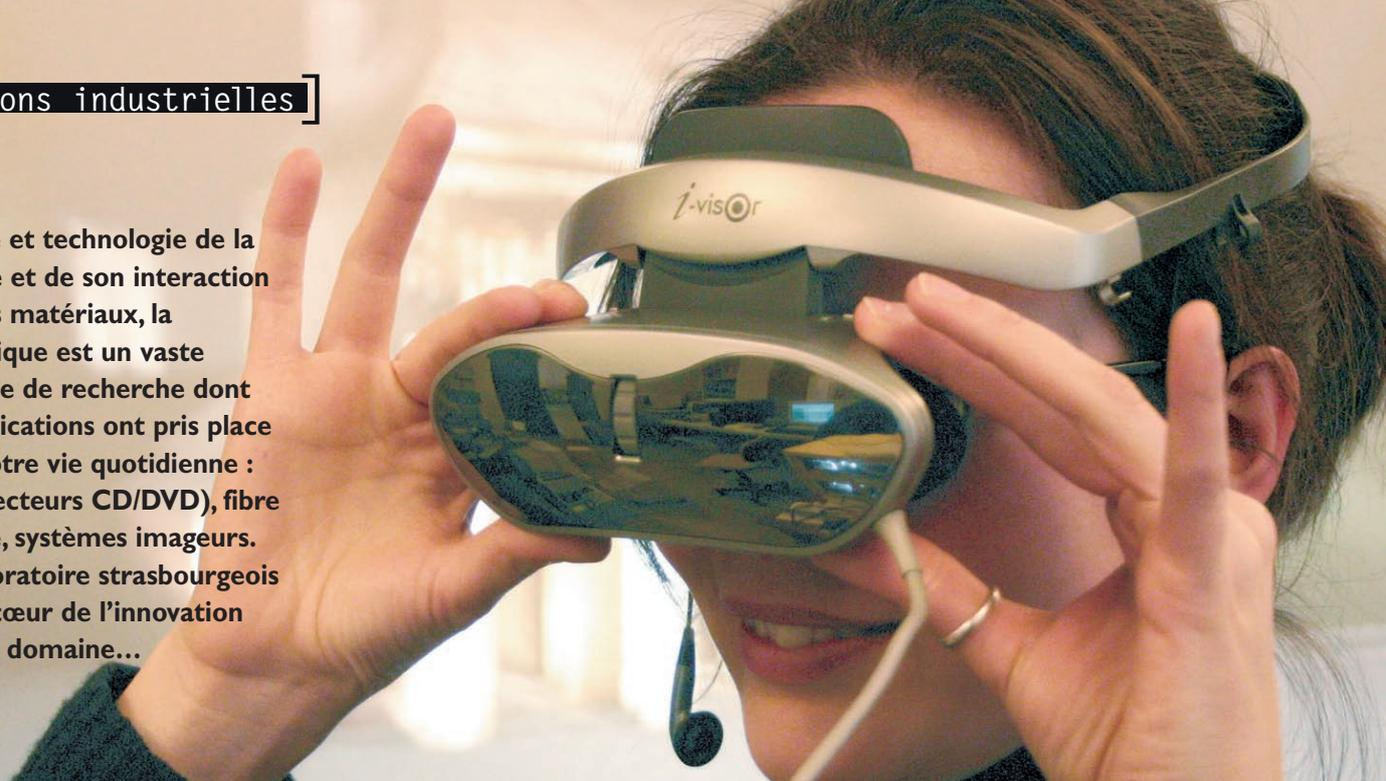
Casque de réalité virtuelle : "système immersif" permettant de visualiser une scène en 3D, sans être gêné par le réel. Le casque de réalité augmentée sera construit sur le même principe et permettra de superposer une image virtuelle à une image réelle. Crédit photo : LSP.
