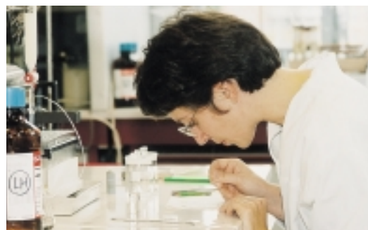
Chromatographie en couche mince permettant de déterminer la composition d'une fraction de parfum.
