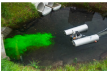
Traçage hydrodynamique réalisé sur l'une des mares du site.
